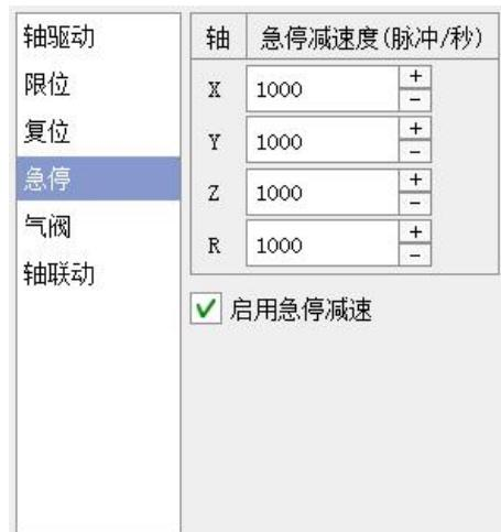
**急停减速度:** 电机运行时, 突然急停, 电机从当前速度以急停减速度, 减速到最小速度后, 停止。此选项, 可以防止, 电机以非常高的速度突然停下。
