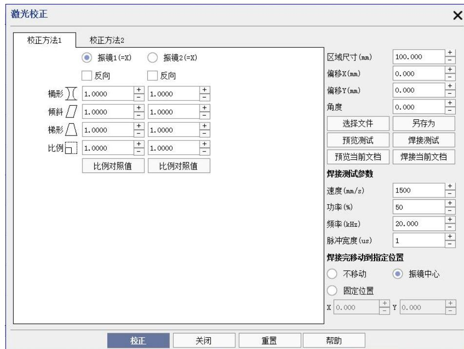
图 6-2-1 激光校正方法 1 界面
